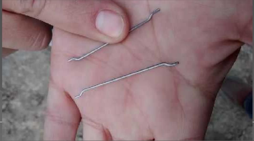
Filamentos de acero de alta resistencia, con dobleces en sus extremos, fabricadas con alambre de bajo carbón estirado en frío.
