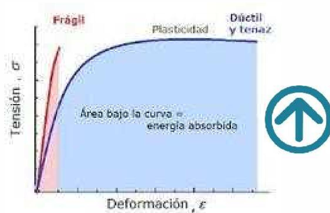
Tenacidad: es la propiedad que tiene el concreto reforzado con Fibras De acero para soportar cargas después del agrietamiento del concreto
